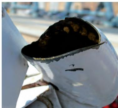
Particolare del montante alare sinistro: si evidenzia la frattura che ha causato l'incidente.
